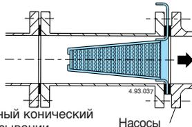
Рис. 5 Временный конический фильтр на всасывании.
