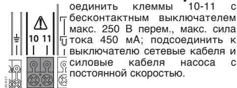
Подключение клеммы 10-11 с бесконтактным выключателем макс. 250 В перем., макс. сила тока 450 мА; подсоединить к выключателю сетевые кабеля и силовые кабеля насоса с постоянной скоростью.
