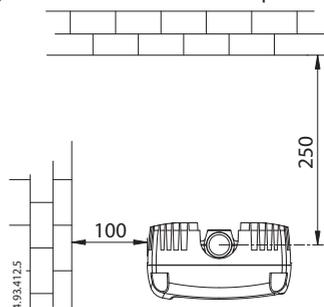
Если расстояния оказываются меньше, подсоединить регулятор частоты с помощью соответствующих патрубков (см. раздел 16.3). Не устанавливать электроцит в местах, подверженных прямому воздействию солнечных лучей и погодных условий или близко к источникам тепла.
