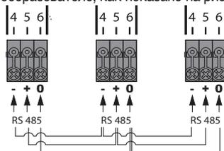
**ВНИМАНИЕ:** Проверить последовательность соединений и убедиться в том, что выводы каждого кабеля подсоединены к клемме с таким же номером.
